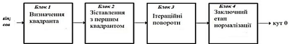
Рис. 5. Чотири етапи обробки квадратурного сигналу на основі алгоритму Cordic
