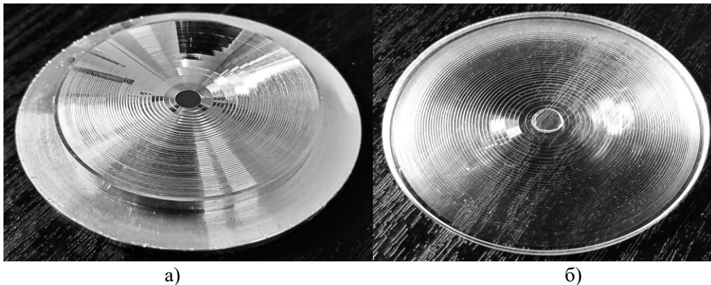
Рис. 4. Загальний вигляд штамп-матриці #32с1m (а) і лінзи #32с1m-#05 (б) з фокусом f_0 = 25 мм і радіусом r_V = 2,5 мм
