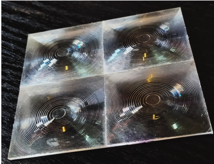
Рис. 16. Блок із чотирьох лінз #32c1-#(07-10) для модуля сонячного фотоперетворювача на основі кремнію: f_0 = 25 мм, r_V = 2,5 мм, розмір кожної лінзи 35 \times 35 мм 2
