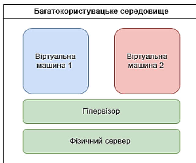
Рис. 5. Виконання додатків різних користувачів віртуальними машинами, що запущені на одному сервері
