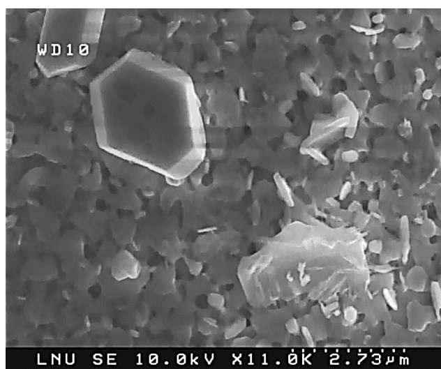
Рис. 4. СЕМ-зображення різних ділянок поверхні закристалізованої плівки (As_2S_3)_{35}(Sb_2S_3)_{32.5}(SbI_3)_{32.5}
